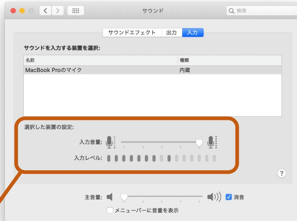
6.「選択した装置の設定」では、上で選択したマイクが正常に音を拾えているかのテストができます。手をたたいたり声を出したりして、バーが動くか確認しましょう。
