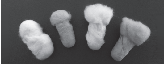
写真3 左からAタイプ綿栓の乾熱前と乾熱後、Bタイプ綿栓の乾熱前と乾熱後
