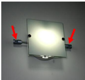
左右の突起(矢印)が、上りと下りの階段を別々に検知するセンサ
